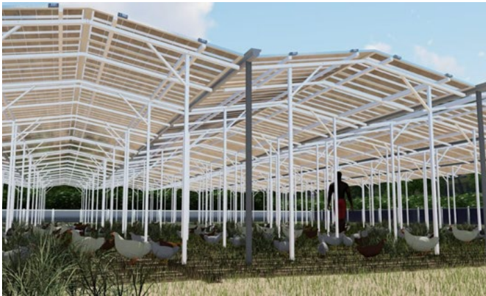
1,1 ha Hühnerfreigehege mit Stall und Wasserführung: 5 m Reihenabstand, 1.100 kWp/ha
