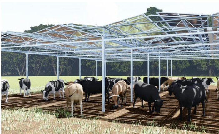
1,1 ha Unterstand für Rinder mit Stall und Wasserführung: 10 m Reihenabstand, 1.100 kWp/ha
